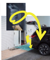
PHVからの給電：災害時に老人ホームで洗濯機・洗濯乾燥機に使用
