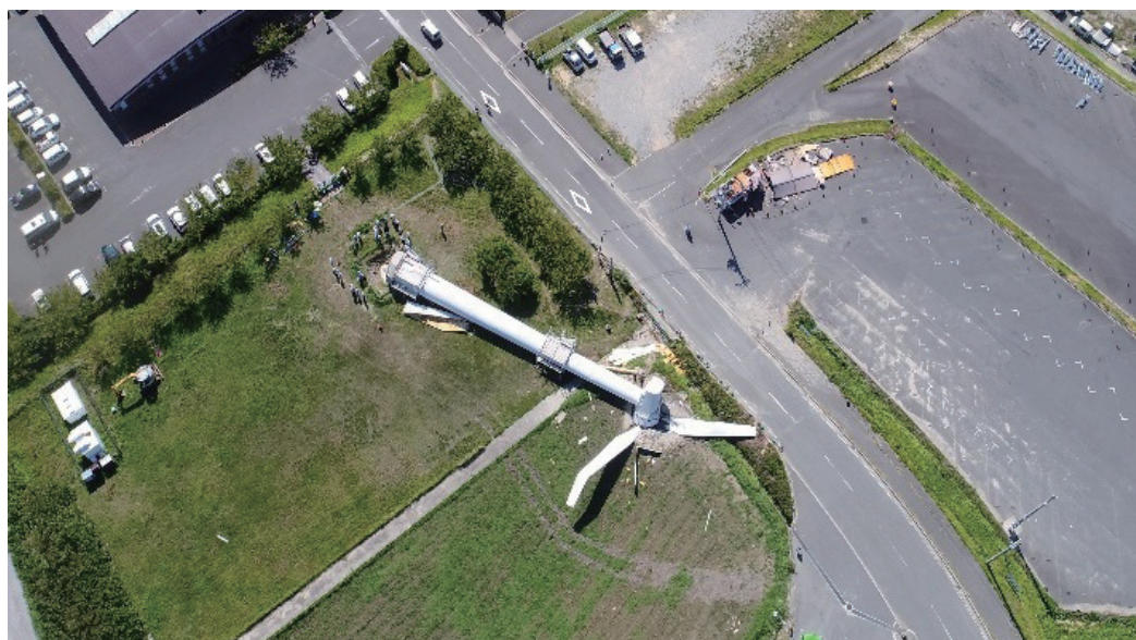
台風による強風で倒壊した風力発電設備
