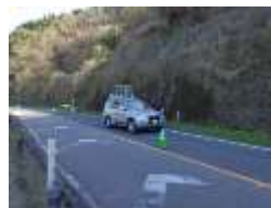
MMS※1を活用した 斜面・のり面点検
