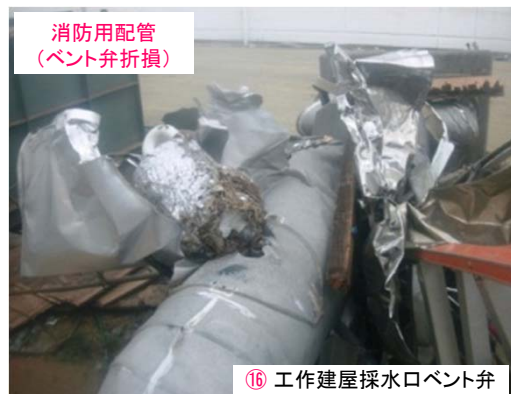
⑯ 工作建屋採水口ベント弁 平成23年3月24日 東京電力撮影
