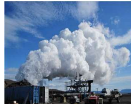
IDDP-1の噴気試験の様子 （坑口状態で） 温度450℃・圧力14MPa 出力30MW相当
