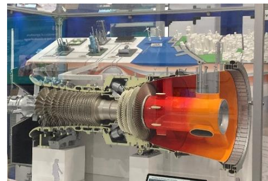
水素専焼ガスタービン (出所) 三菱重工業より写真提供
