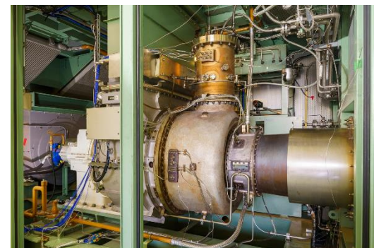
アンモニア専焼ガスタービン (出所) IHI
