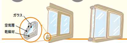
窓の断熱リフォーム
