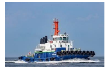
アンモニア燃料タグボート「魁」 （出所）日本郵船株式会社
