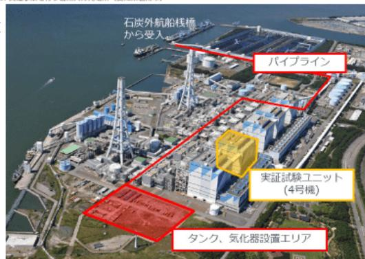
実証試験では、定格出力運転において20%転換を達成。転換前と比較して、NOxは同等以下、SOxは約20%の減少を確認。
