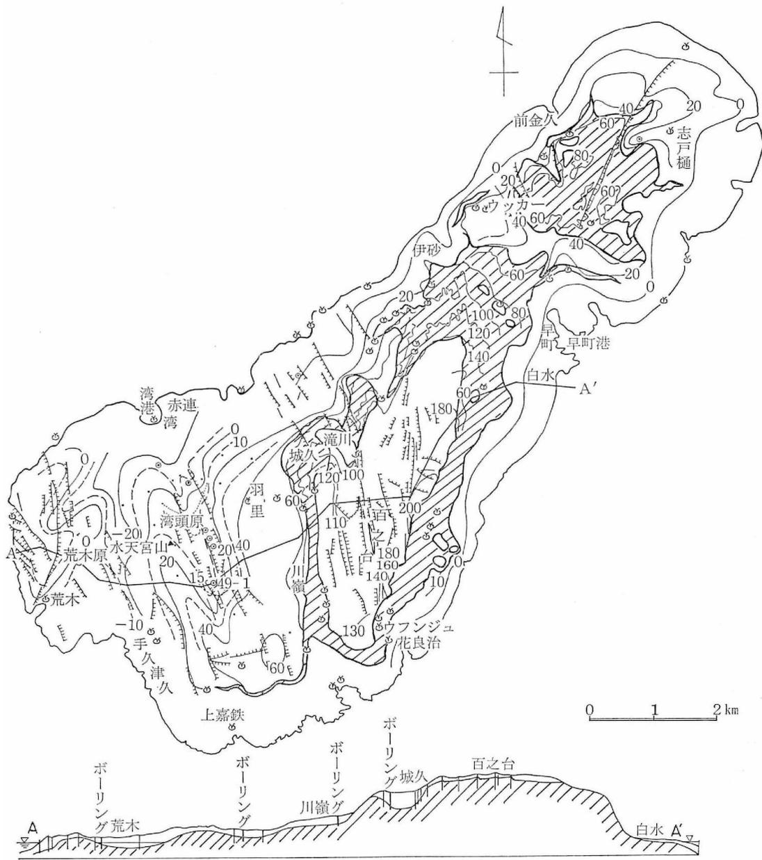
□ 石灰岩(石灰砂層を含む)    ▨ 泥岩砂岩互層    ⊕ 湧水    ⊙ 地下水開発成功井    ● 地下水開発失敗井、小口径ボーリング
