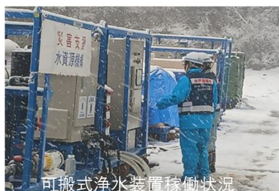
可搬式浄水装置稼働状況
