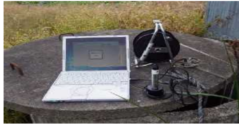
自記水位計に測定・蓄積されたデータをPCに回収
