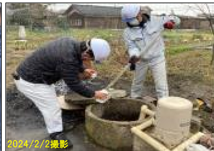
既設井戸水からの採水状況
