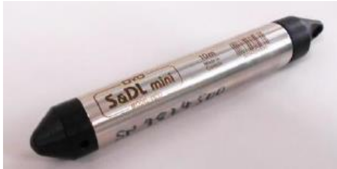
地下水位を自動測定する 自記水位計
