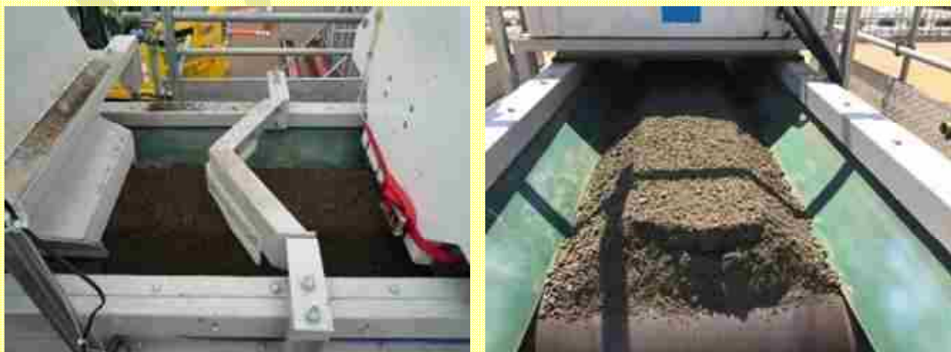
図 2-5 ベルトコンベヤによる放射能濃度測定装置 (南相馬市仮置場における試験盛土造成実証事業の例)
