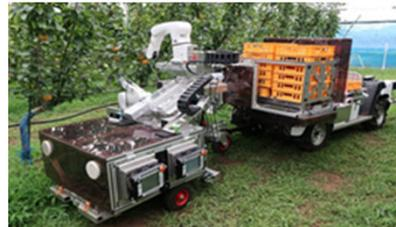
ナシ自動収穫ロボット (電動農機)
