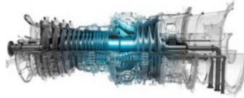
【水素ガスタービン 燃焼器】
