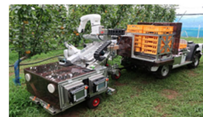
ナシ自動収穫ロボット (電動農機)
