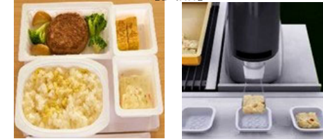
ロボットが盛り付けしやすいパッケージに自律的に惣菜の盛り付けを実施
