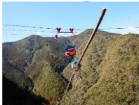
（架線式グラブプルによる集材作業）
