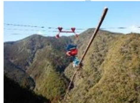
（架線式グラップルによる集材作業）
