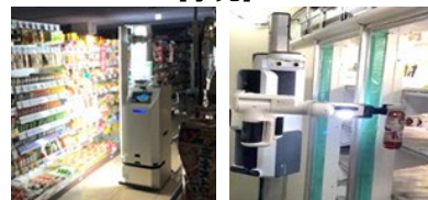
ロボットによる在庫管理・品出し
