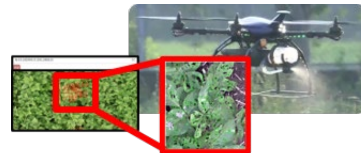
AI・ドローンによるピンポイント散布による減農薬・減肥料
