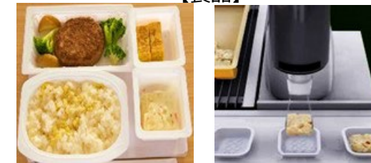
ロボットが盛り付けしやすいパッケージに自律的に惣菜の盛り付けを実施
