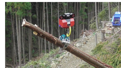
自動化機械を活用した 架線集材
