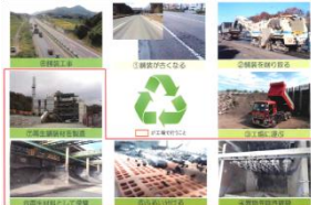
アスファルト舗装のリサイクル
