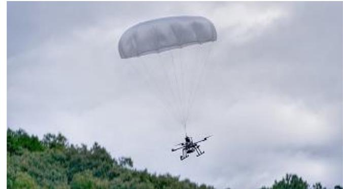
兵庫県内での実証を経て令和4年2月に販売開始したドローンパラシュート装置の実演を実施。飛行中に不測の事態が生じた時にパラシュートが展開することで落下速度が減速し、被害を軽減。ソフトウェア面だけではなく、物理的な安全性も高めることで、レベル4でのドローン社会実装に貢献することを目指す。
