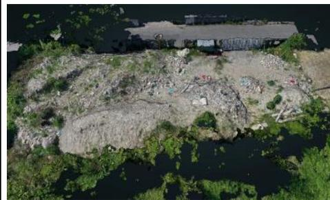
行政職員がドローン空撮・オルソ画像作成・点群データ作成を実施。事業系廃棄物の体積計算や堆積物の傾斜計測、現場状況確認、指導後の進捗把握などで、使用に耐えうるレベルで運用できることを確認。
