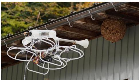
バキュームタイプのハチ駆除用ドローンを用いて、危険性(刺される、高所、熱中症の危険、夜間など)の高いハチ駆除作業を、ハチ駆除件数が全国トップクラスの兵庫県において実施。
