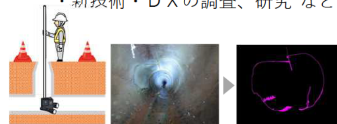
高解像度カメラを用いた管口カメラ調査 （画像認識AIによる劣化判定の効率化（開発中））
