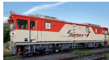
【SMART-i】 新幹線線路設備モニタリング 装置を搭載した専用保守用車
