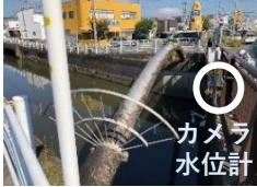
市内の河川にビデオカメラと水位計を設置し、定点監視。撮影した動画を独自技術で解析。
