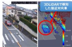
①カメラ画像と3DLiDAR画像
