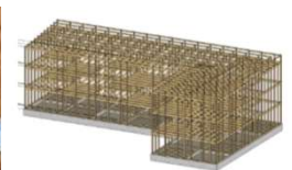
木造建築物のBIMモデル
