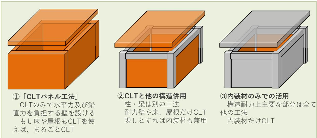
図2 CLTの多様な選択肢のイメージ
