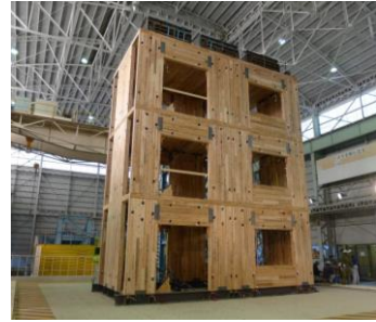
CLTパネル工法建築物の振動台実験の様子
