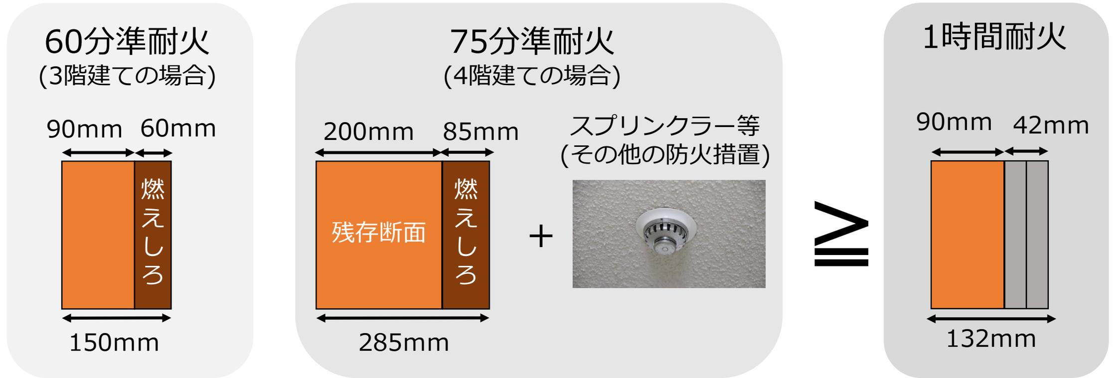
75分準耐火構造では、要求準耐火時間の1.2倍(90分)の準耐火性能が求められる
