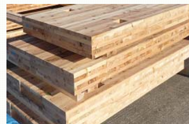
CLT 1枚約220kg (1m×3m×厚さ18cm)
