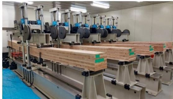
CLTの長期的な強度性能の測定
