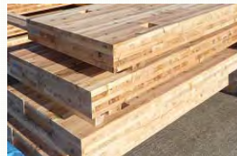
CLT 1枚約220kg (1m×3m×厚さ18cm)
