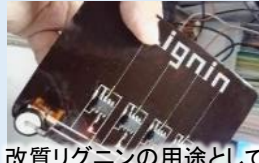
改質リグニンの用途として期待される電子基板
