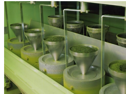
茶加工施設【左：レンガ式てん茶製造施設 右：粉碎機（石臼）】
