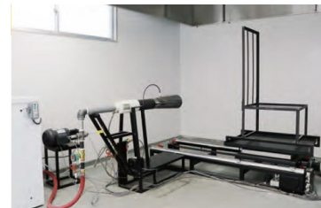
＜燃焼・耐火性試験装置＞
