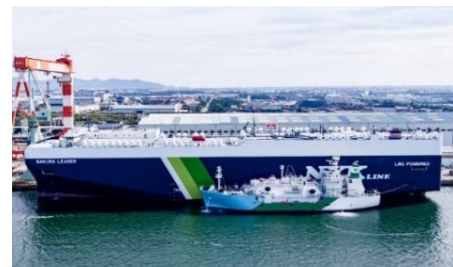
<LNGバンキングの様子>
