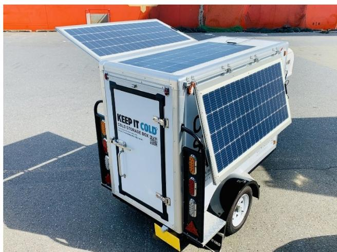
普通のモデルに加え、ソーラーエネルギーシステムを搭載し、再生可能エネルギーによる発電・蓄電を活用した自立運用が可能です。これにより、未電化地域や発展途上国でも迅速にコールドチェーンを導入できます。
