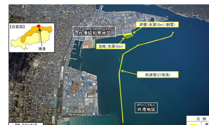
境港における岸壁、泊地の整備
