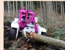
伐採作業の自動化・遠隔操作化
