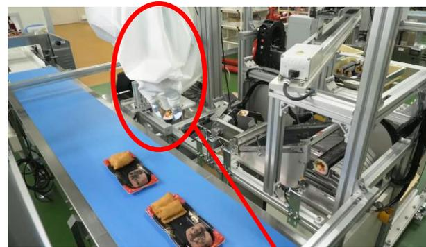
柔らかい具材にも対応可能な触覚ハンドを用いたロボットの開発現場
