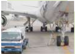
充電、圧縮空気・冷暖房 の供給、給水
