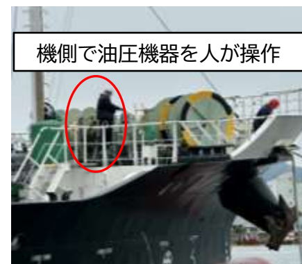
機側で油圧機器を人が操作 係船作業や投錨作業時の ウインチ操作の様子
