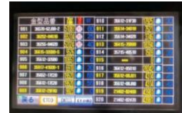
金型のメンテナンス時期を知らせるアラーム表示
