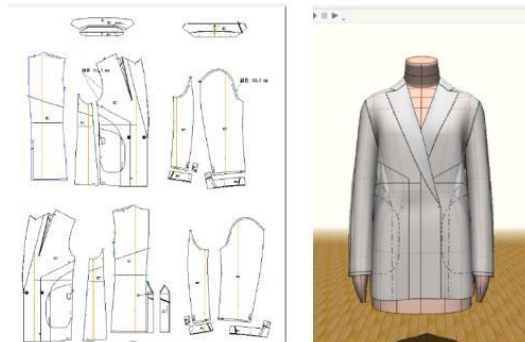
3DCADによる工業用パターン作成
