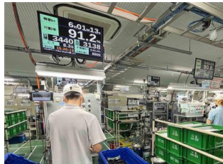
ラインごとの稼働率や工場全体の稼働状況が見える化
