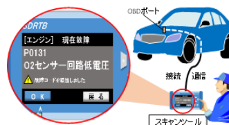
車両コンピューターに接続して故障診断
