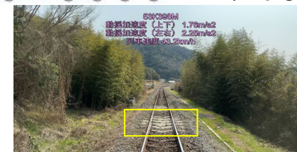
線路点検業務の自動化の例(軌道状態評価システム)
