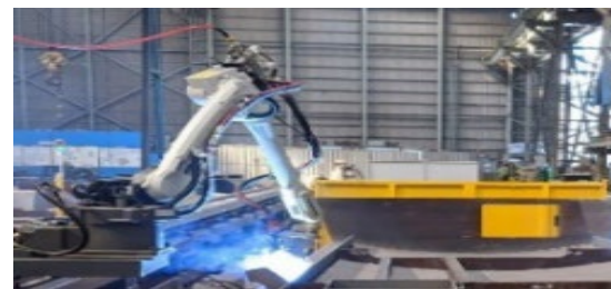
自動溶接ロボット(真鍋造機株)
