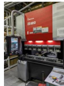
導入した部材曲げ加工装置
