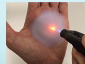
99%空気でできた断熱素材。僅か数mmの厚みで1000℃以上の炎も断熱。
