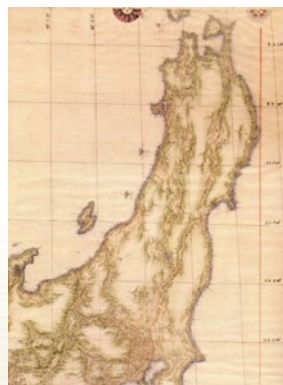
図5: 東北日本 南北線の記入（鉛筆黒線を八島邦夫氏が赤線で補筆）経度補正のための作業痕跡
